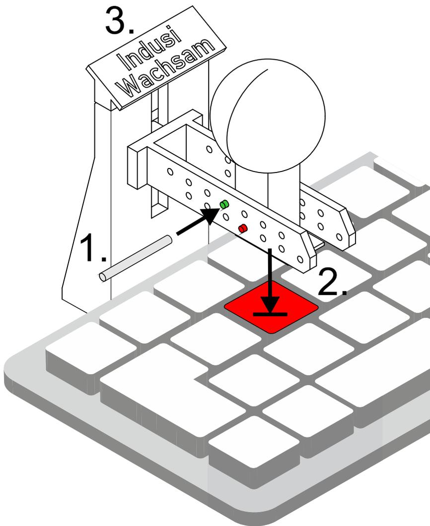
Führen Sie nun einen zweiten Zylinderstift ein **(1)**, und war ein Loch weiter hinten in der oberen Reihe - dieser dient als Anschlag, so das der Hebel nur nach vorne bewegt werden kann.
