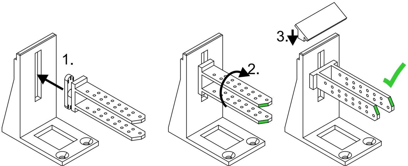
Führen Sie den Ausleger durch den Schlitz der Basis **(1)** und drehen diesen vorsichtig um 90° **(2)**, so dass die langen Schrägen nach oben zeigen (im Bild grün markiert).
