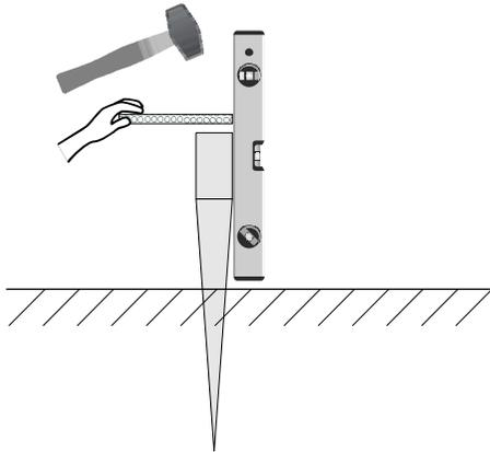
Bringen Sie den Erdspeiß mit Hilfe eines Hammers und einer Wasserwaage lotrecht in das Erdreich ein.
