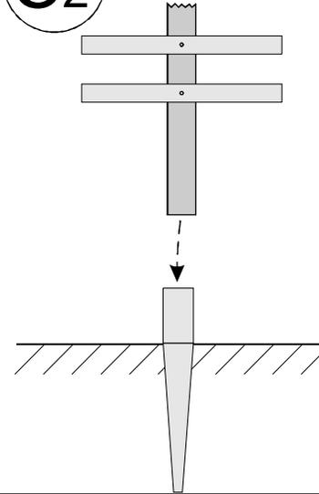
Stellen Sie nun das fertige Rankgitter in den Erdspeiß. Richten Sie dieses mit einer Wasserwaage in allen Richtungen aus. Bohren Sie dann das erste Montageloch vor, wie in C3 abgebildet, und drehen eine Holzschraube ein (erstmal nur handfest).
